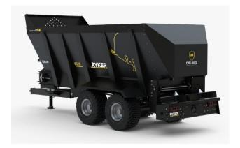
Стойка к аброзивному воздействию ST-52 с толщиной 10 мм на днище и 6 мм на бортах емкости
